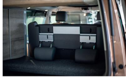
2. Mit dem Knopf unten in der Mitte die Kopfstützen nach hinten klappen.
