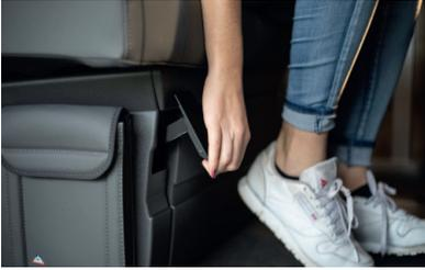
1. Mit dem Hebel die Rückbank so weit wie möglich nach vorne schieben.
